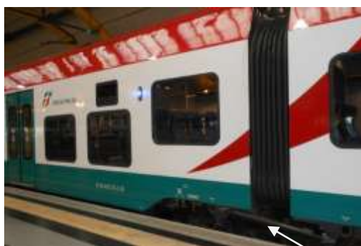
写真23：レオナルドエクスプレス連結面 ローマ空港駅にて（10月2日）ダンパー
